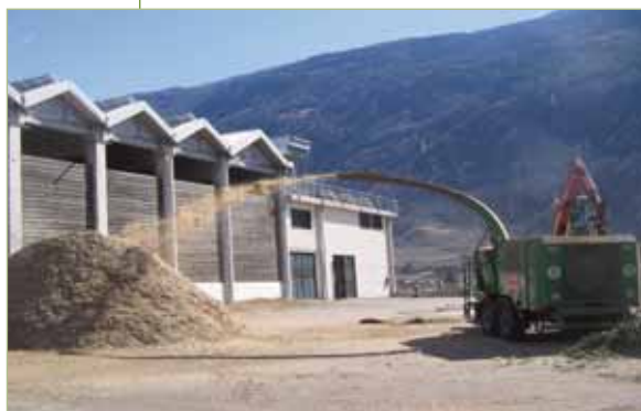
Soc. di Teleriscaldamento e Cogenerazione Valtellina, Valcamonica e Valchiavenna Centrale di Tirano: operazione di cippatura
