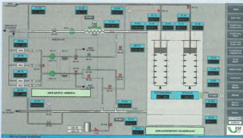
La tecnica consiste nell'integrare, in un'unica unità d'impianto, due tra le più efficaci tecnologie di depurazione dei fumi di combustione: la depolverizzazione attraverso la filtrazione con maniche in tessuto e la denitrificazione ( $\text{DeNO}_x$ ) mediante reazione di Selective Catalytic Reduction (SCR), che riduce con elevata efficienza gli  $\text{NO}_x$  ad azoto e acqua impiegando come agente riducente ammoniacale o urea in un reattore catalitico.
