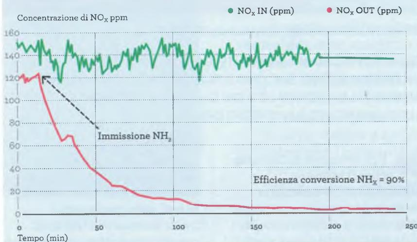
Come evidenziato dalle successive Figure 4 e 5, alle due temperature sono state costantemente ottenute efficienze di conversione degli NO<sub>x</sub> molto elevate e pari al 90 e 70 per cento, rispettivamente alla temperatura di 200 e 140 °C.
