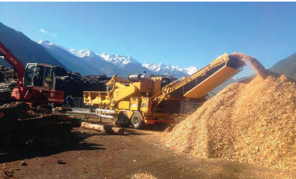
FASE DI CIPPATURA DEI RESIDUI LEGNOSI IN UNA CENTRALE DI TELERISCALDAMENTO A BIOMASSA
