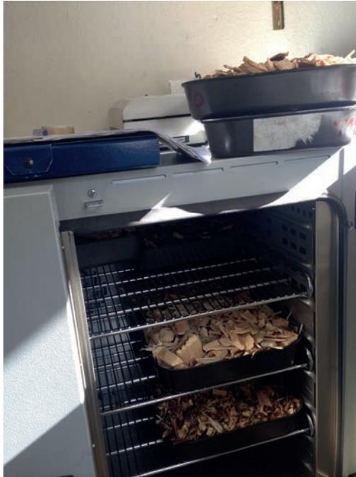
Figura 4 - Forno per prove umidità. Fonte: Cofely impianto di Sellero
